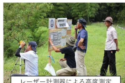
レーザー計測器による高度測定
